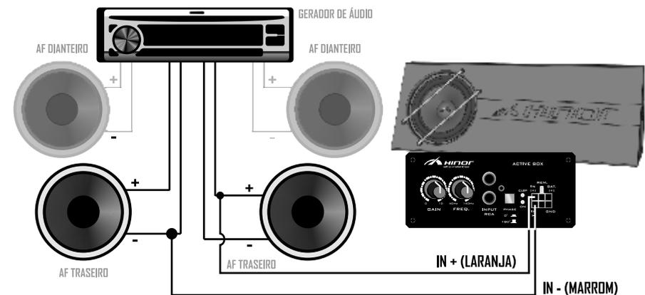
Este exemplo ilustra a ligação através da saída amplificada do gerador de áudio. Liga-se o cabo IN + na saída positiva do AF traseiro direito e o cabo IN - na saída negativa do AF traseiro esquerdo.
