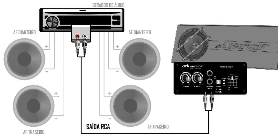
Este exemplo ilustra a ligação através da conexão RCA do gerador de áudio.
