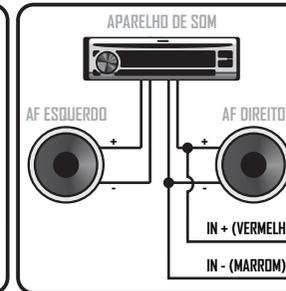
Este exemplo ilustra a ligação através da saída amplificada do gerador de áudio. Liga-se o cabo IN+ na saída positiva do AF e o cabo IN- na saída negativa do AF. (Observar nas imagens ligação em mono ou stereo)
