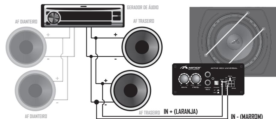
Este exemplo ilustra a ligação através da saída amplificada do gerador de áudio. Liga-se o cabo IN + na saída positiva e IN - na saída negativa.
