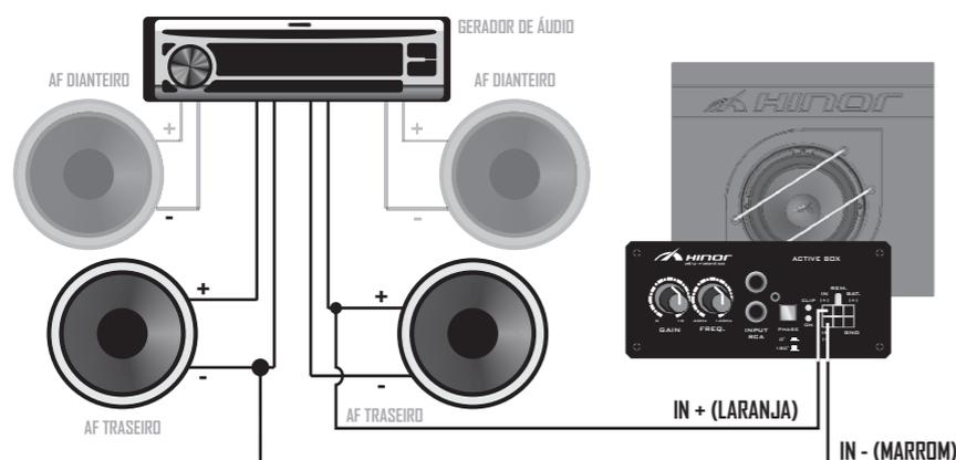
Este exemplo ilustra a ligação através da saída amplificada do gerador de áudio. Liga-se o cabo IN + na saída positiva do AF traseiro direito e o cabo IN - na saída negativa do AF traseiro esquerdo.
