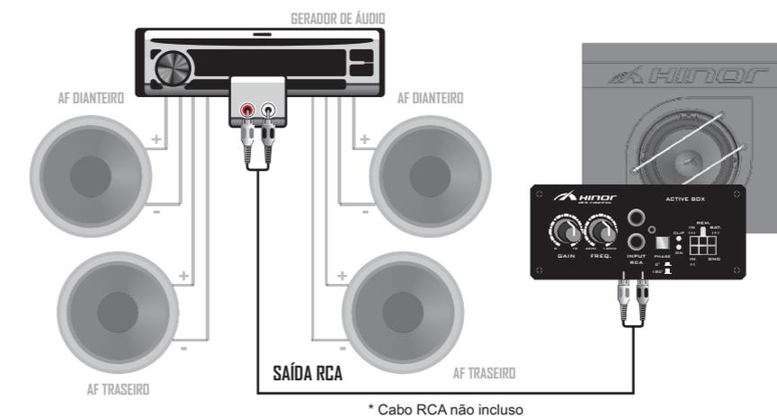
Este exemplo ilustra a ligação através da conexão RCA do gerador de áudio.
