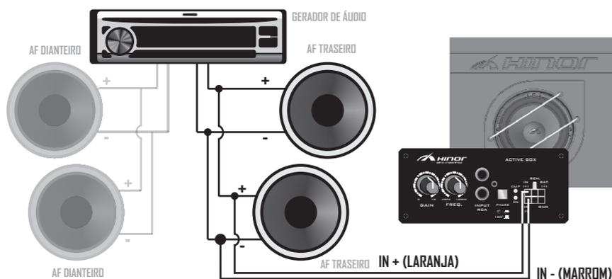
Este exemplo ilustra a ligação através da saída amplificada do gerador de áudio. Liga-se o cabo IN + na saída positiva e IN - na saída negativa.
